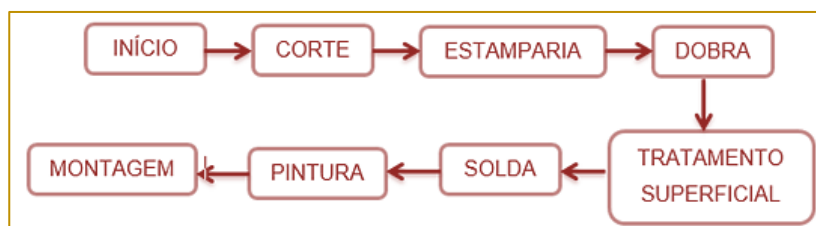
Figura 1 - Fluxograma Do Processo De Produção Da Metalúrgica
