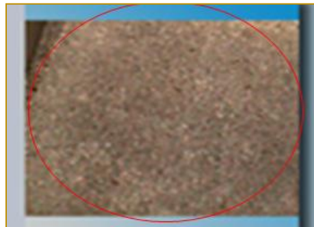
Figura 10 – peça fosfatizada sem pintura. Fonte: nelson do brasil, (2014).
