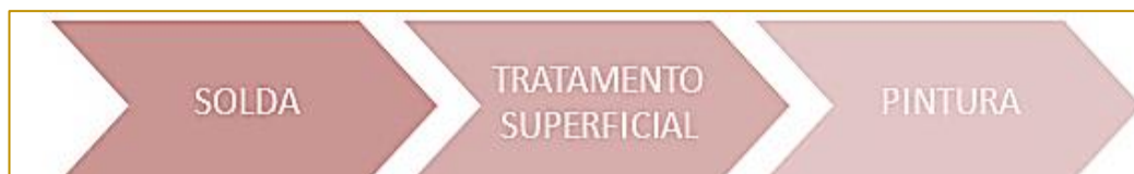
Figura 4 - Fluxograma Do Processo De Tratamento Superficial Correto
