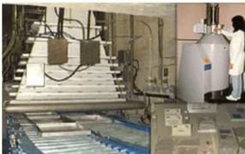
Figura 4 - Acelerador de elétrons e Gammacell utilizados para esterilização por radiação
